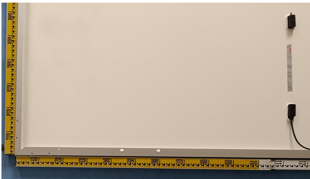
图 18 接地孔及安装孔位置
